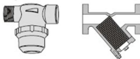
Pour les applications avec une forte concentration de magnétite dans l'eau, comme les circuits en boucle ouverte ou fermée avec un taux de fuite élevé, un filtre avec une fonction magnétique est fortement recommandé. Non seulement il empêchera le BPHE de se colmater, mais il protégera également la pompe à eau contre l'érosion.
