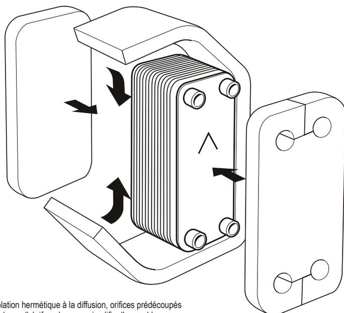
\*Isolation hermétique à la diffusion, orifices prédécoupés et ruban adhésif au dos pour simplifier l'assemblage.
